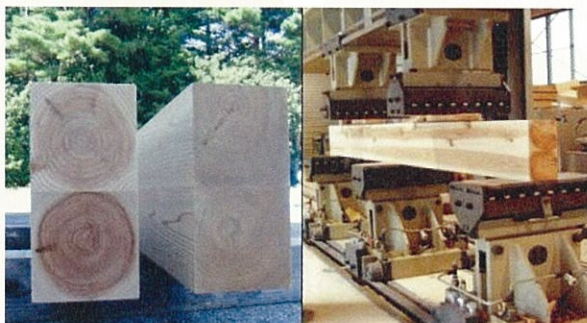
▲接着重ね梁と強度試験の様子
