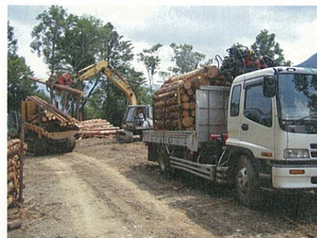
▲作業路からフォワーダで搬出された木材を林道に集積・トラック運搬の状況
