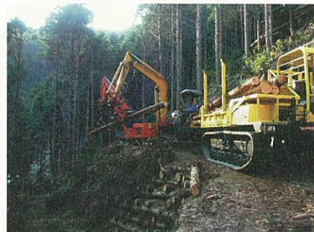
▲作業路を開設して、高性能林業機械による利用間伐の状況
