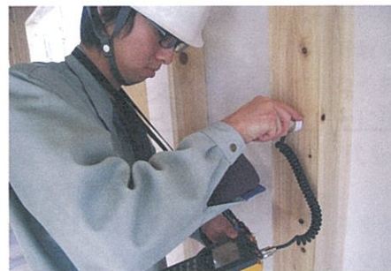
▲含水率の測定（構造材は20%以下）
