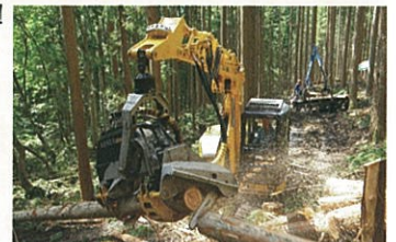
▲伐倒、枝払、玉切の一連作業ができる最新の林業機械
