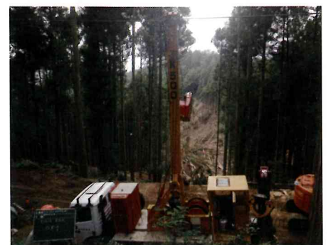
▲タワーヤーダ+ウッドライナーの組み合わせた集材
