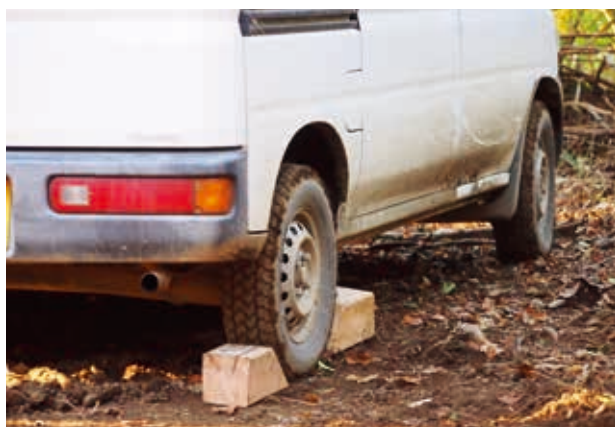
▲駐車時の輪止めを徹底している
