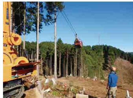
▲タワーヤードを用いた架線系集材システム
